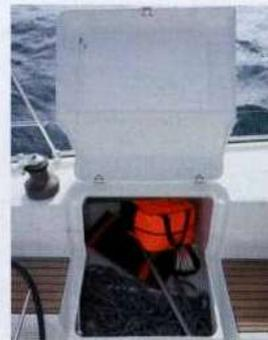
A sinistra, uno dei due gavoni ricavati sotto le panche del pozzetto, dove stivare la zattera. Oltre a questi c'è un vano separato per due bombole del gas.
