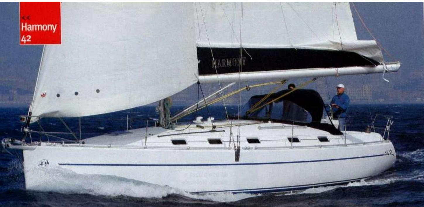
Con 22 nodi di vento reale, invelati con genoa al 105% e una mano alla randa, la barca è più volte partita in surf. Ottima la stabilità di rotta.
